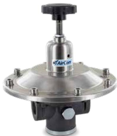
**Beschreibung** Der Niederdruckregler hat einen auf 50 mbar fest eingestellten Ausgangsdruck und ein integriertes Sicherheitsventil (Ausnahme: R01-415), welches bei ca. 130-150 mbar öffnet. Daher ist der Regler bei Gasdruckregelung nicht in geschlossenen Räumen zu verwenden.
